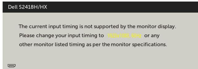
Това означава, че мониторът не може да се синхронизира със сигнала, който получава от компютъра. Вижте [Технически характеристики на монитора](#) относно диапазона на хоризонтална и вертикална честота, които са адресирами за този монитор. Препоръчителният режим е 1920 x 1080.
