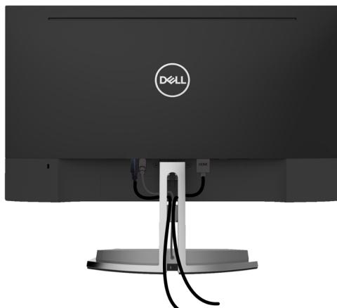
След прикрепване на всички необходими кабели към монитора и компютъра (вижте [Свързване на Вашия монитор](#) за прикрепване на кабелите) организирайте всички кабели, както е показано по-горе.
